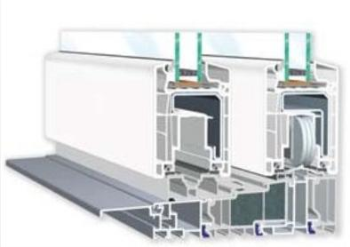
Le coulissant Veka Slide, système soulevant coulissant, avec son dormant 170mm à 7 chambres et ses ouvrant 70mm 5 chambres permettant d'accueillir notre gamme de triple vitrage, ce coulissant atteint un  $U_w=1.2$  en double vitrage et  $U_w=0.88$  en triple vitrage. Il permet également de très grandes dimensions jusqu'à 6500mm. Son système de joint exclusif vous garantit une étanchéité totale. Son système de seuil permet un encastrement total et donc de ne pas avoir de marche dans le passage.
