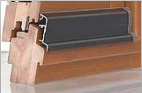
Rejet d'eau aluminium laqué aux lignes esthétiques de série sur toutes nos menuiserie bois, cette pièce protège efficacement la pièce d'appui de la fenêtre contre les intempéries, elle permet d'accroître la longévité de la fenêtre
