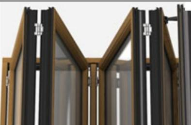
Le coulissant accordéon, fabriqué en profil Softline 70 AD, ce coulissant permet de profiter de l'intégralité de la baie, les vantaux se replient sur eux même afin d'obtenir une ouverture totale, coulissant également à frappe avec une compression double joints, il permet d'obtenir les mêmes coefficients des fenêtres du même profil,  $U_w=1.2$  en double vitrage et  $U_w=0.88$  en triple vitrage. Dimension maximale de 4000mm.
