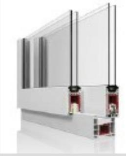
Le coulissant Ekosol, coulissant 1 ou 2 vantaux, en profil de 70mm, pouvant accueillir un vitrage jusqu'à 26mm d'épaisseur, équipé d'une crémaillère multipoints de fermeture, réalisation possible jusqu'à 3500mm de longueur.  $U_w=1.4$  avec  $u_g=1.0$
