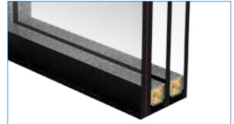
Triple vitrage 44.4/14/4/14/4 SÉCURITÉ
